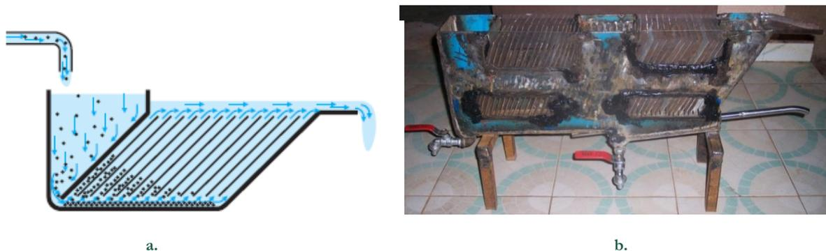
Figure 12 : a. Coupe longitudinale du décanteur lamellaire mis au point par le projet ALTERRE
