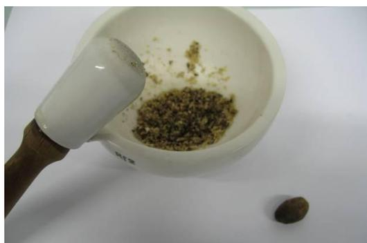
Figure 17 : Broyat de graines de jatropha dans un mortier en porcelaine
