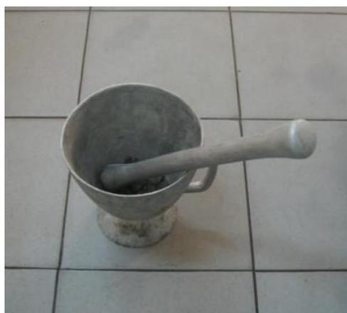
Figure 18 : Mortier et pilon en aluminium utilisés pour broyer des échantillons de graines dont la masse dépasse les 5g
