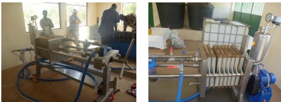
Figure 11 : Filtre presse à plateaux à Teriya Bugu
