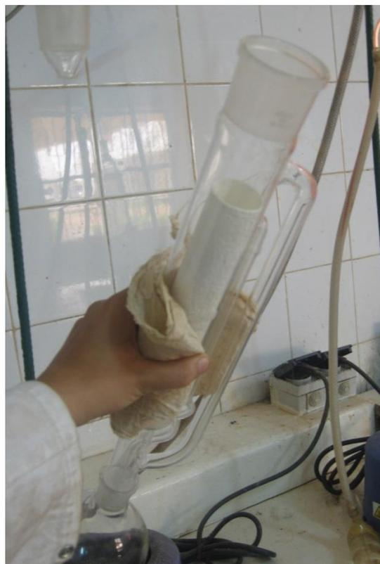
Figure 19 : Cartouche en cellulose insérée dans le corps extracteur de l'appareil Soxhlet
