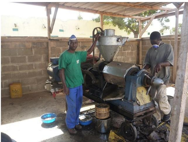
Figure 10 : Presse à anneaux utilisée pour les essais de pressage du projet ALTERRE
