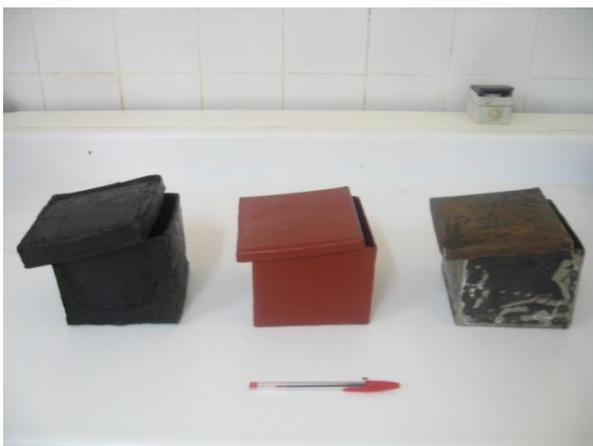
Figure 23 : Récipients 11,5×11×10 cm constitués de g. à dr. de caoutchouc dur, de métal recouvert d'une peinture anti-oxydante et de métal
