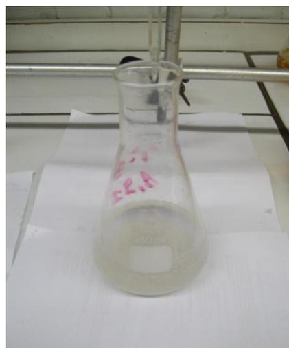
Figure 27 : Solution incolore obtenue lors du point de fin de titrage de la mesure de l'indice peroxyde
