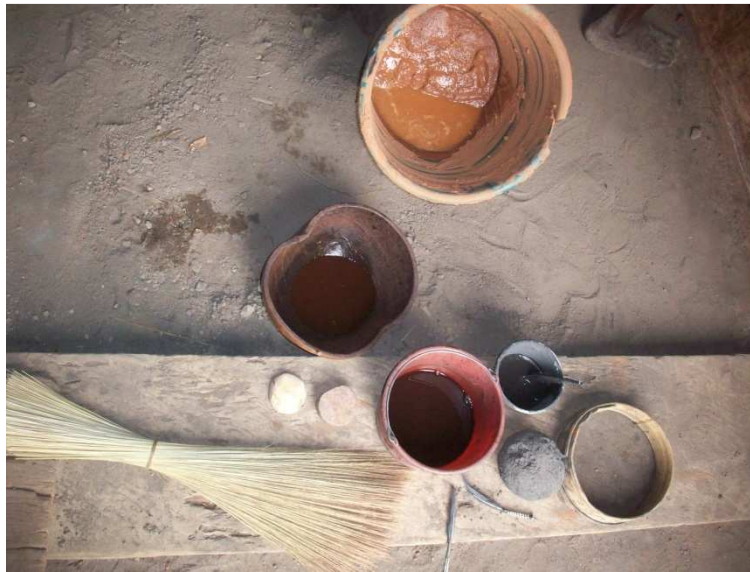
Figure 28: Matériaux et matériel servant à faire l'enduit traditionnel. En haut, la latérite mélangée. En bas, de gauche à droite : les brindilles servant à projeter la latérite, la craie, le galet pour lisser, le vernis de Néré, les plumes de pintades pour peindre, la pierre de graphite, le graphite pillé mélangé et le tamis pour la latérite.
