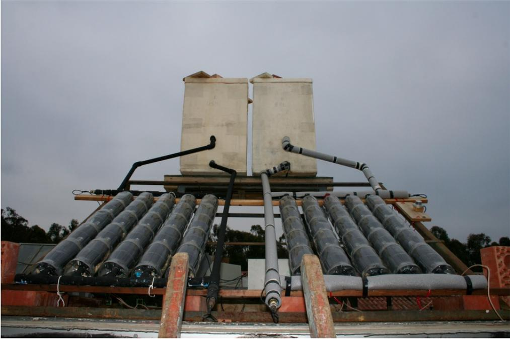
FIGURE C.1 – Essai A : revêtement des tuyaux de connexion. Vue de la structure d’essai.
