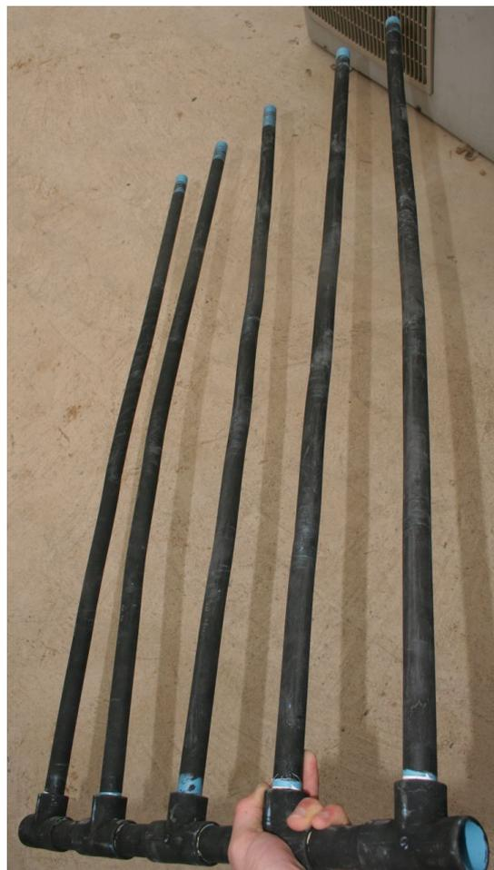
FIGURE D.3 – Déformations d'un capteur PET isolé.
