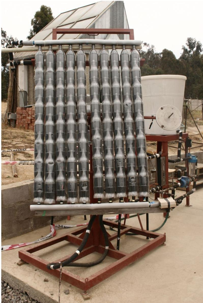
FIGURE 3.13 – Collecteur utilisé lors des essais de rendement instantané.
