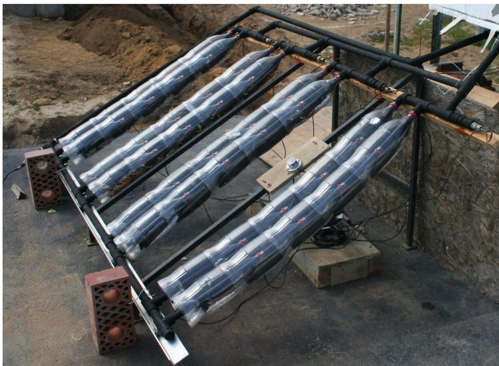
FIGURE D.1 – Structure d'essai pour la comparaison préliminaire d'isolant.
