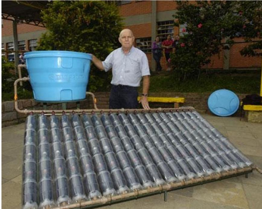
FIGURE 3 – Prototype de capteur PET réalisé par José Alano. Photographie : Tarsila Pereira.
