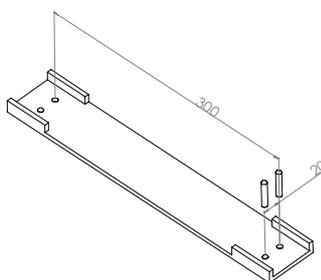
Figure 14 : gabarit de perçage de la courroie
