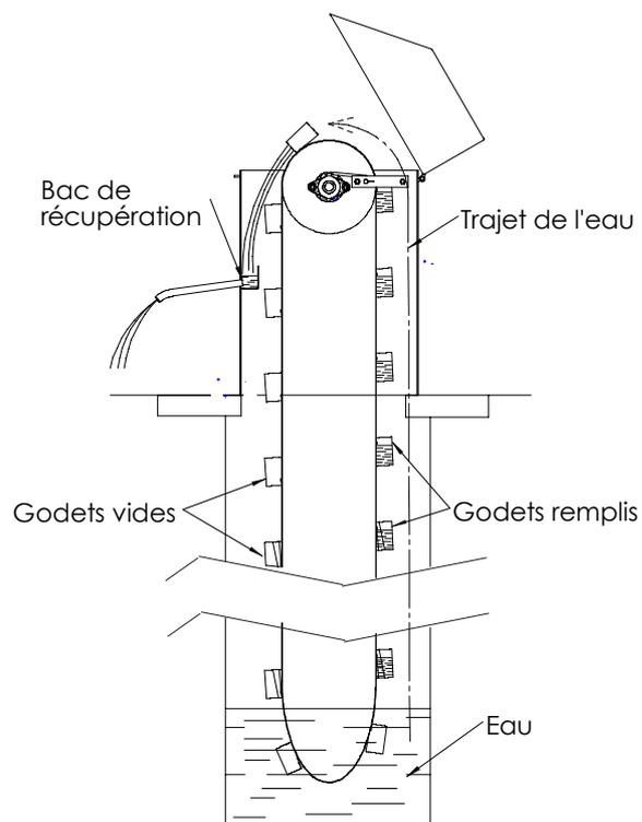
Figure 2 : schéma de principe
