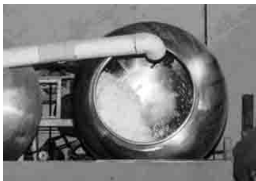
Photo 4.7 : Séchage à l'air chaud de flocons de plastiques (Cuernavaca, 1998-2002)
