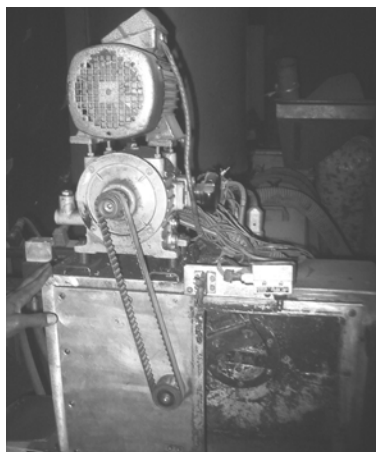
Photo 5.6 : découpage direct des filaments en sortie de filière
