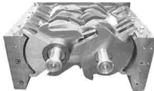
Photo 4.11 : Principe de la cisaille rotative
