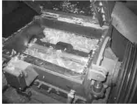
Photo 4.13 : Zone de broyage d'un broyeur à axe horizontal
