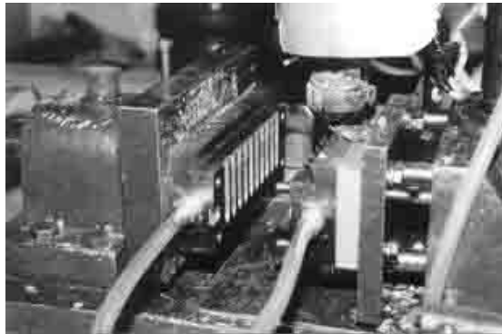
Photo 5.11 : moule à 10 empreintes et son système de refroidissement hydraulique
