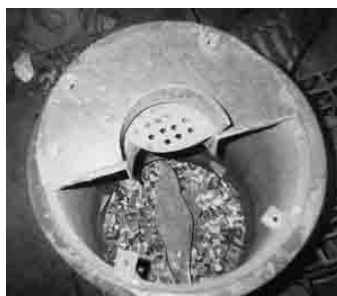
Photo 4.16 : Vue intérieure d'un agglomérateur
