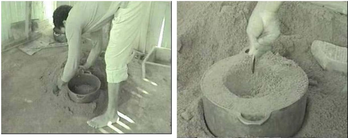
**Figure 14 : Remplissage de sable de la partie creuse de la marmite. Serrage et évidement afin d'alléger l'ensemble.**
