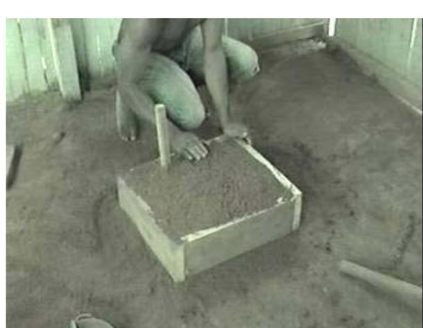
**Figure 17 : Positionnement d'un tube de bois qui fera office de modèle pour la descente. Le sable doit être bien séré à la base pour maintenir le bois en position. Remplissage du moule par du sable.**
