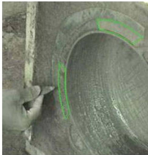
**Figure 19 : On taille les attaques**
