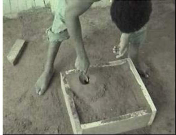
**Figure 18 : On taille l'entonnoir qui doit posséder une face droite (voir schéma de gauche – vue du haut de l'entonnoir) afin d'éviter la création d'un vortex qui entraînerait de l'air et des crasses dans l'empreinte.**
