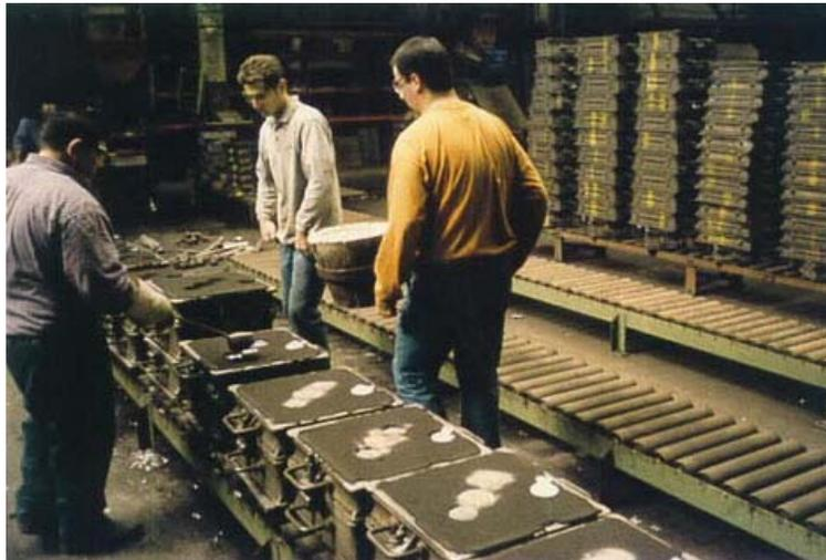
**Figure 31 : Saupoudrage de poudre à réaction exothermique sur la masselotte**
