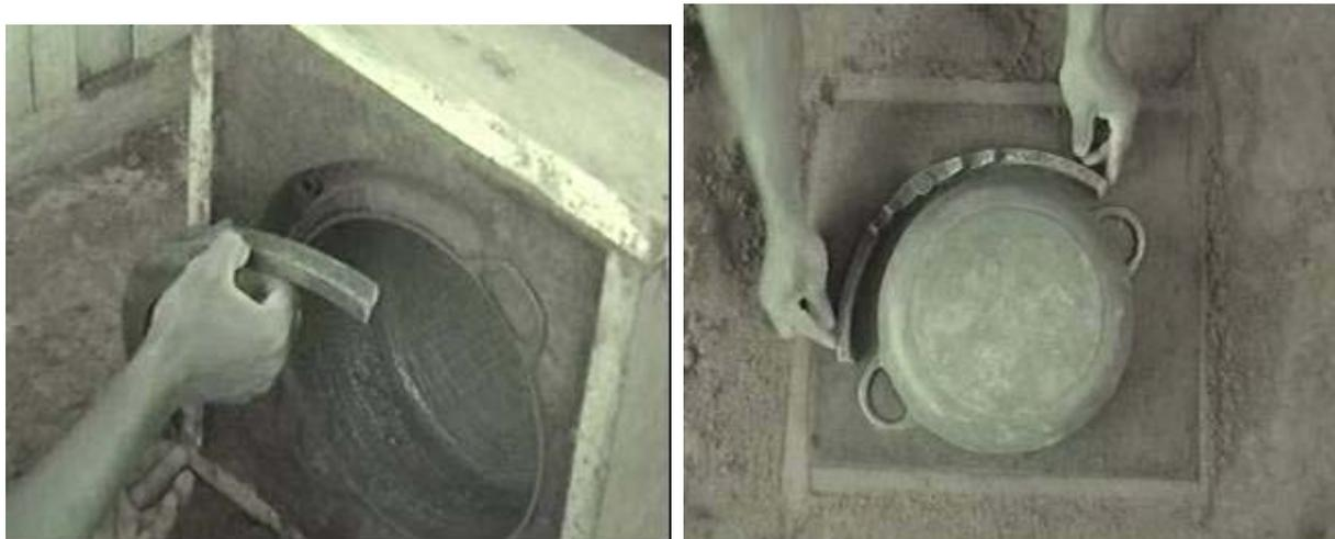
**Figure 20 : Démoulage du chenal qui a pu être taillé soit dans la partie supérieure du moule (à gauche) soit dans la partie inférieure (à droite)**
