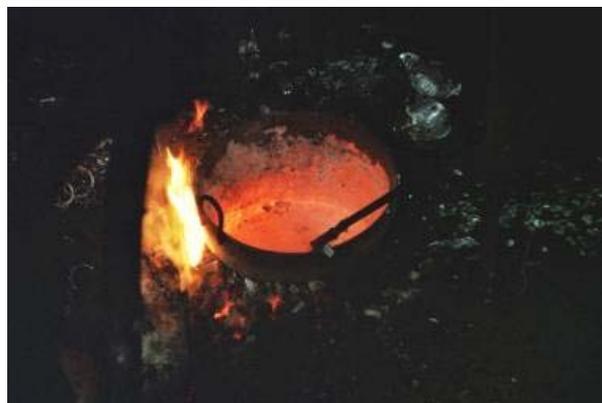
**Figure 25 : Creuset contenant de l'aluminium en fusion**
