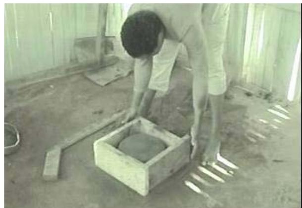
**Figure 16 : Mise en place de la marmite sur le lit de sable et d'un châssis en bois.**
